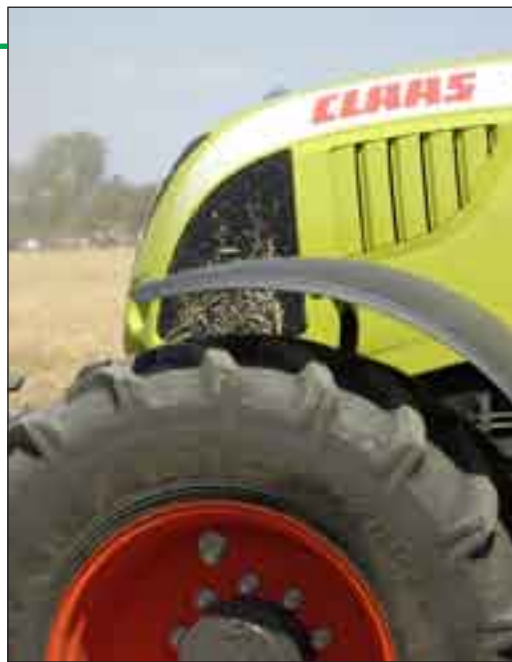
Um Schäden durch Überhitzung entgegenzuwirken, sollten die Zuluftgitter regelmäßig gereinigt werden. Foto: Wobser
